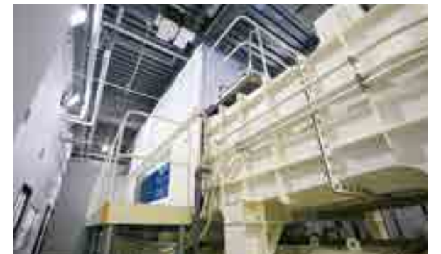
流水の抵抗を活かし、通常より高い負荷を掛けながらトレーニングを行うことができる実験施設「流水プール」。部屋のサイズに合わせたオーダーメイド製だ。
