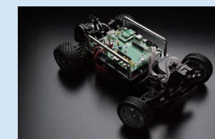
インターネットに接続し、自動運転にも応用可能な様々な状況を実験できるT-Car
