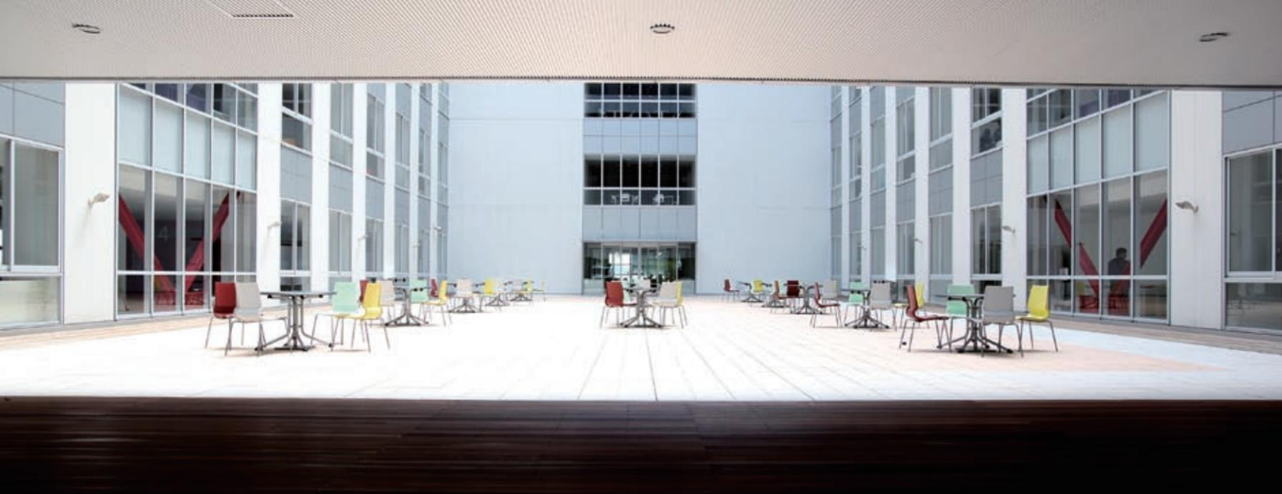
吹抜けを利用した中庭形式のプランにより、自然採光と自然換気を実現したキャンパスプラザ。「コージェネレーションシステム」や「ライトシェルフシステム」などを採用したエコキャンパスだ。
