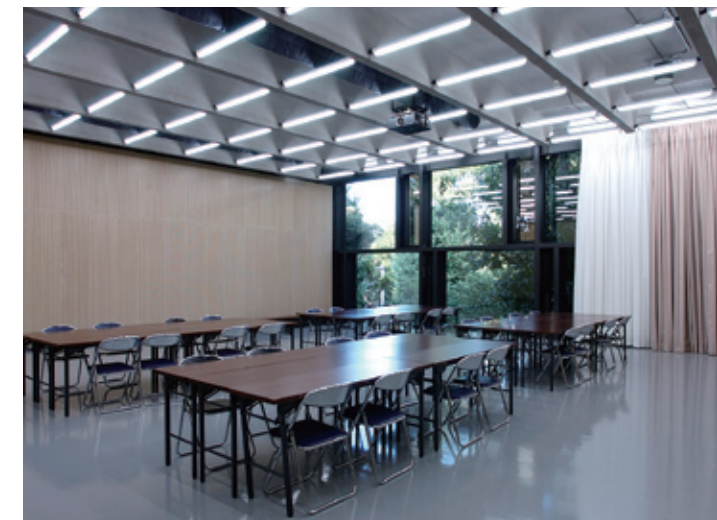
北側採光のデッサン教室。モデル台に人が立つため天井高は高く、自然光を補助する蛍光灯、完全遮光または視界を遮り光のみ通すカーテンなど、質実剛健の設備。
