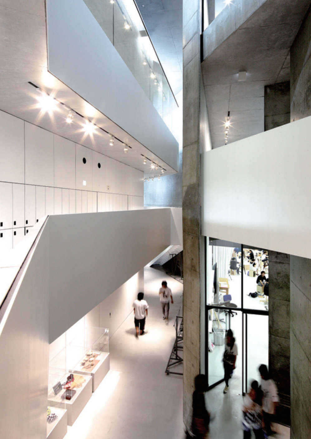
吹き抜けを中心に各階を半階ずつずらすステップフロアを採用。デッサン室の天井高を確保した効率的な断面計画だ。
