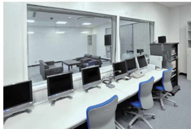
工業製品を開発する際に、人間がどういった反応を示すかを観察するユーザビリティラボ。脳波を測定し、マジックミラー越しに反応を観察する。(1号館)
