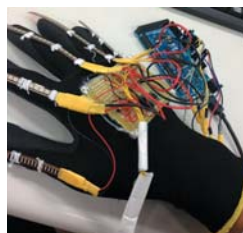
「手指動作入力装置の製作と取得情報の活用」という課題研究テーマで製作されたデータグローブ
