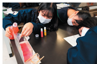
海洋鉛直循環を再現する実験。インクを使うことで、冷やされた水が沈み込み、底で広がるといった動きを確認。そのあとで、表面を真水の層が覆っても鉛直循環が起きるかを実験した。
