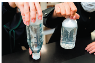
竜巻を再現する実験。底が凸凹のボトルでは逆さにして回すと渦ができ、底が平面のボトルでは逆さにしないでも渦ができる。竜巻の避け方として気象庁の情報の活かし方も学ぶ。
