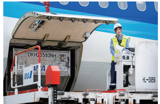
荷物の積み下ろしは、「ハイリフトローダー」と呼ばれる特殊車両を操作して、地上10mほどの高さで行われる。
