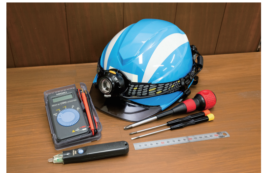
仕事道具は上から時計回りにヘルメット、ドライバー、部品を測る定規、電気が通っているか確認する検電器2種。
