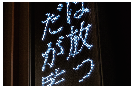
字幕用の電光掲示板は町工場の職人さんと一緒に開発したものの。100kgほどになる機材を現場で組み上げ設置する。
