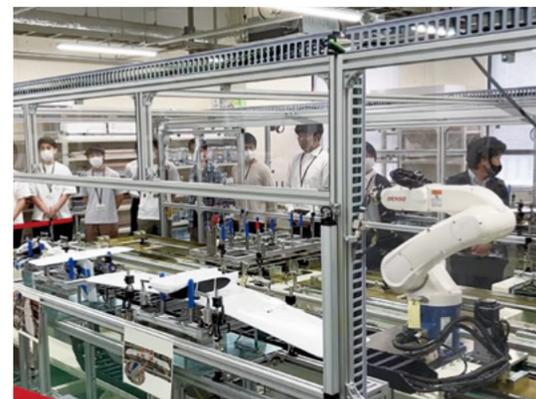
模型飛行機自動組み立て装置を使った生産管理演習
