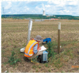
2010年、ニュージーランドのオハアキ地熱発電所地域で地熱貯留層の重力モニタリングを行っている写真。遠くに見える、大きな冷却塔が地熱発電所。
