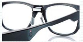
鼻パッドと眉間部分に仕込んだ三点式眼電位センサー。
